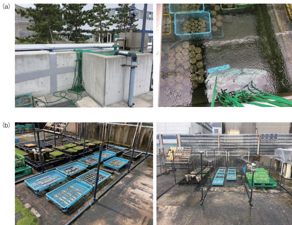
図1 海洋暴露試験で使用された海水循環水槽 (a) および海水シャワー場 (b) Fig. 1 Seawater pool (a) and seawater shower area (b) used for marine exposure tests.
