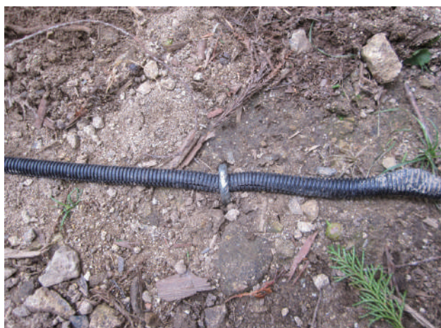
Photo3. 誘導電線および固定方法 Induction wire and fixing method
