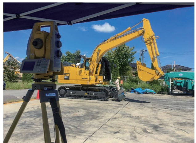
Photo 1. TS を用いた精度測定試験の様子
