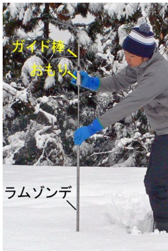
Photo 11. ラムゾンデを用いたラム硬度の測定 Measurement of Ram hardness using the rammsonde
