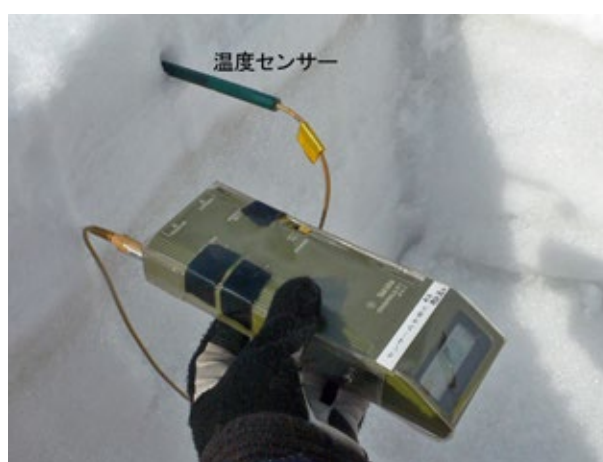
Photo 5. 雪温の測定 Measurement of snow temperature
