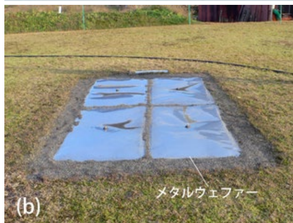
Photo 3. (a) 神室型スノーサンプラーを用いた積雪水量の測定 (b) メタルウェファー式積雪重量計
