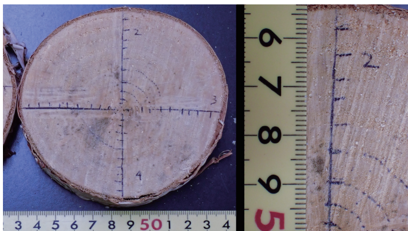
Photo 1. 左: 測定した円盤の例 (標本木 9、高さ 1.3 m)。右: その円盤の拡大写真
