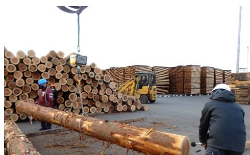
写真1 縦振動法による固有振動数の測定の様子
