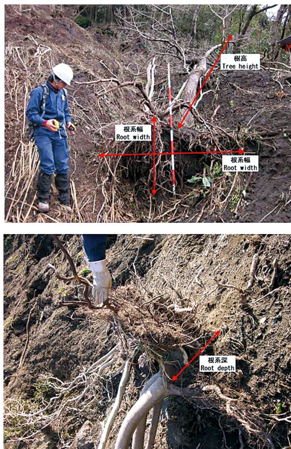
Fig. 2 倒木の計測項目 (樹高、根系深、根系幅) と計測位置 Survey method (tree height, root depth and root width)
