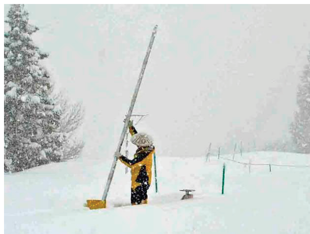
Photo 3. 神室型スノーサンプラーを用いた積雪水量の測定 Measurement of snow-water equivalent using the Kamuro-type snow sampler
