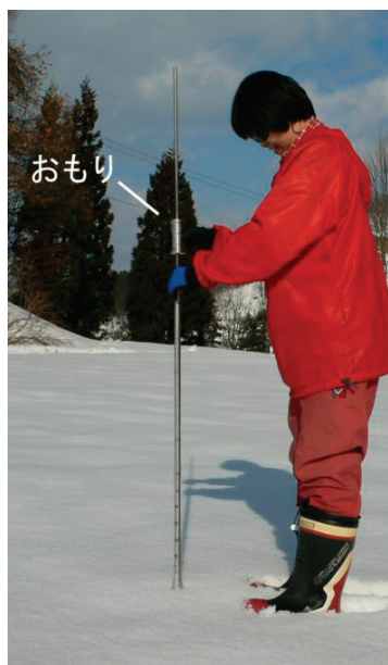
Photo 9. ラムゾンデを用いたラム硬度の測定 (竹内ら 2009) Measurement of Ram hardness using the rammsonde
