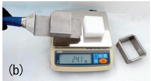
Photo 5. 密度の測定 (a) 密度サンプラー (b) 採取した 100 cm 3 の雪の質量を測定 (竹内ら 2009) Measurement of snow density (a) Sampler for measuring snow density (b) Measurement of the mass of 100 cm 3 snow
