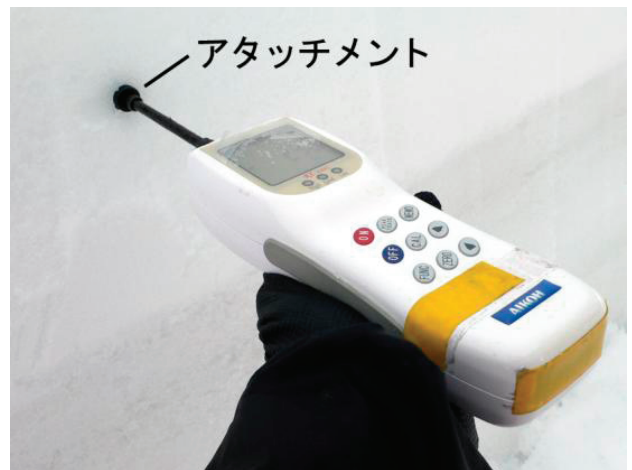
Photo 8. プッシュゲージを用いた硬度の測定 (竹内ら 2009) Measurement of snow hardness using the push-gauge
