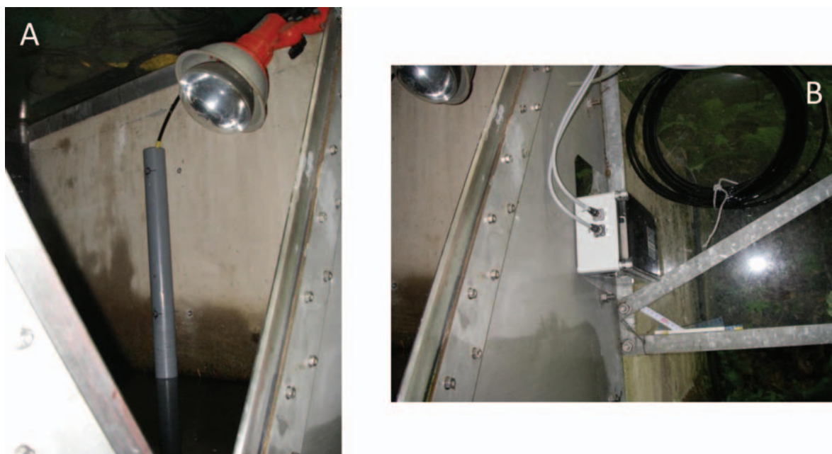
Photo 1. 新たに追加した圧力式水位計(A: センサ部; B: ロガー)
