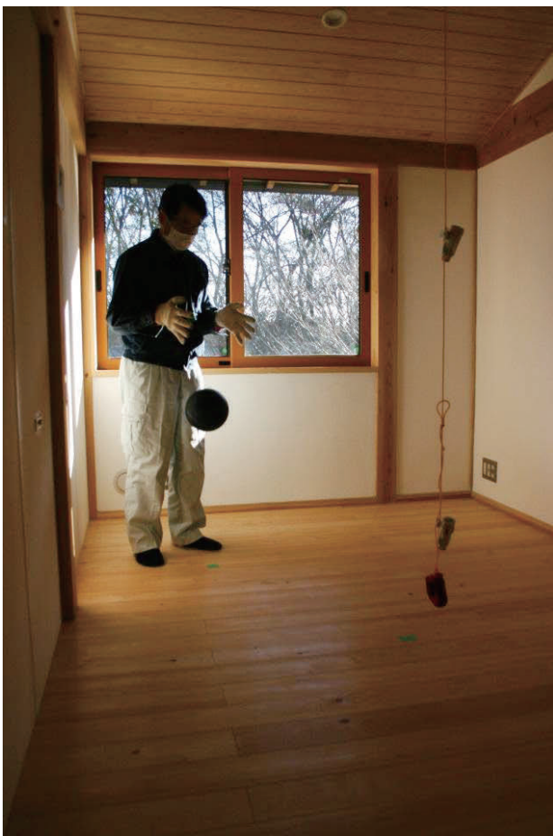
写真 2. インパクトボール（重量床衝撃源） Photo 2. Impact ball (heavy floor-impact source).
