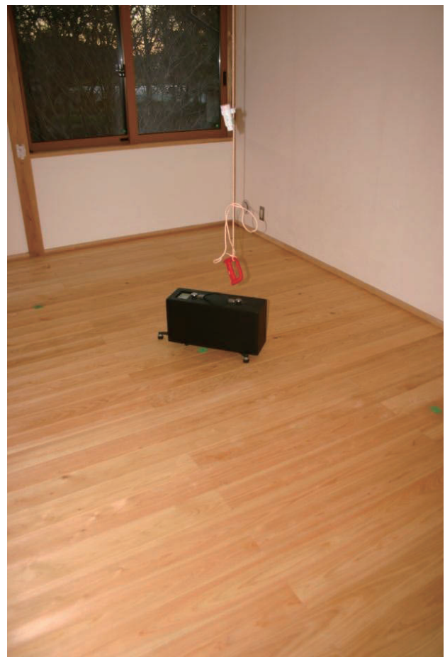
写真 3. タッピングマシン（軽量床衝撃源） Photo 3. Tapping machine (light floor-impact source).
