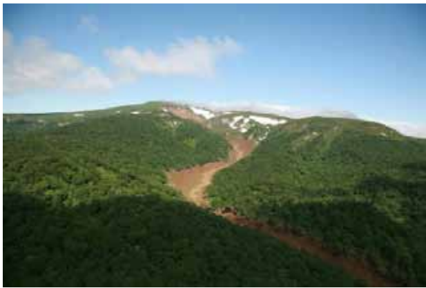
Photo 8. ドゾウ沢土石流。発生点には残雪が見られ、崩壊発生箇所が湿潤であったことがわかる。崩壊は一気に土石流化した様であり、側岸を侵食しながら流下している。Dozouzawa debris flow. The outbreak point covered with snow beds indicates a wet ground condition at the earthquake. A landslide fluidized immediately. The debris flowed downstream at high velocity with eroding the stream bank.
