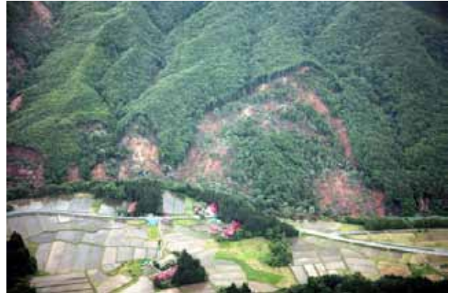
Photo 2. 市野々原地すべり (朝日航洋 (株) 撮影)。右側の最大のブロックが閉塞を発生させた。Ichinonohara landslide. The right block of the landslide dam up the river. The photo was taken by Aero Asahi Corporation.
