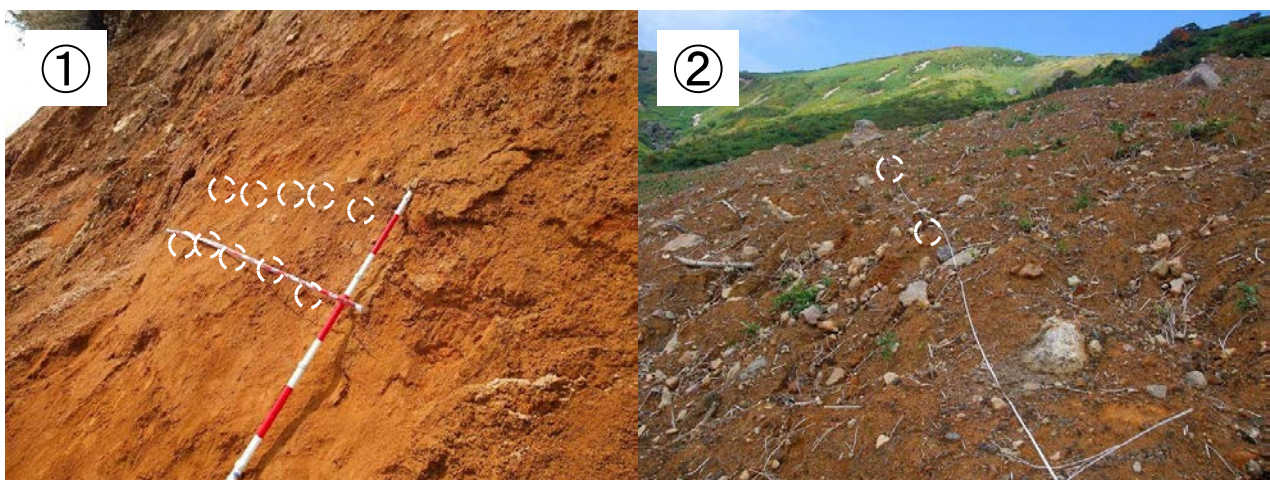
写真 1 B1, S1, S2 の地表面、丸破線は侵食ピンの位置 ① : S1, ② : B1, S2 Photo 1. Ground surface at B1, S1 and S2. A broken circle is erosion pins. ① : S1, ② : B1, S2
